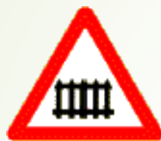
有柵門鐵路平交道
